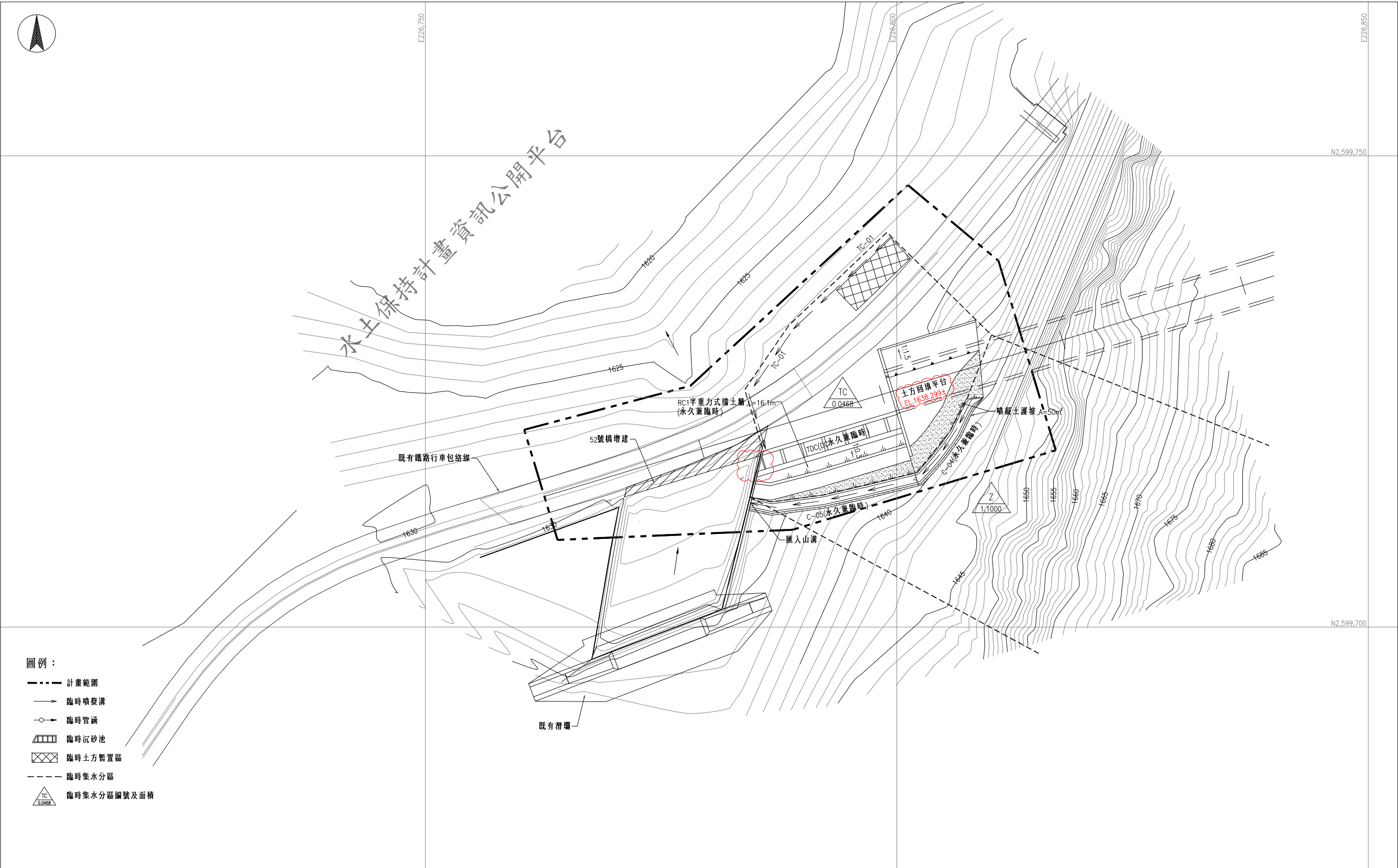
隧道西洞口臨時性安全排水平面配置圖 A1=1:200 A3=1:400 Unit:m
